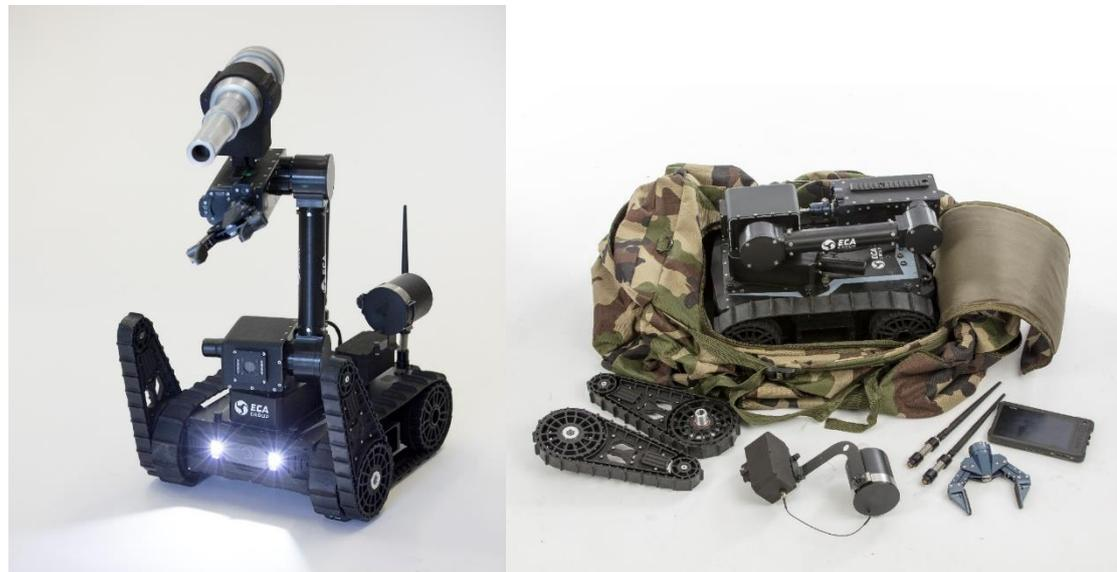
Léger (12 kg) mais polyvalent (charge utile 15 kg) le robot [CAMELEON LG](#) peut être équipé d'un bras manipulateur (capacité de levage de 4,5 kg) ou de capteurs (télémètre laser, capteur radiologique, chimique caméra thermique, etc.), afin s'adapter aux besoins de la mission avec un rayon d'action jusqu'à 500 mètres il peut gravir des pentes de 45°.
