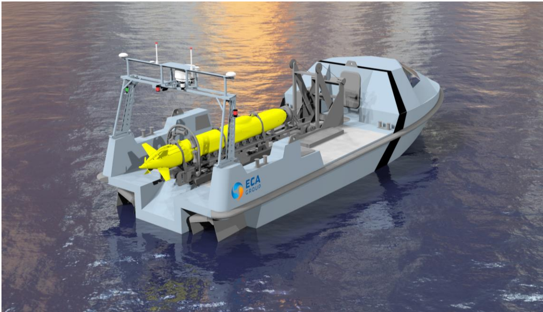
INSPECTOR 120 avec un AUV de taille moyenne et son système de lancement et de récupération
